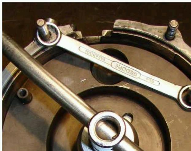
Das serienmäßige Amerikanische Ritzel des Starters habe ich runtergedreht (erfordert eine sehr stabile Drehbank weil gehärtet) und stattdessen das 15Z Modulzahnrad mit 2K Kleber aufgeklebt. (Hier geht nur kleben weil die Nabe den Endlagen-Anschlaggummi aufvulkanisiert hat) Trotzdem mußte am Kurbelgehäuse eine kleine Einfräsung gemacht werden:
