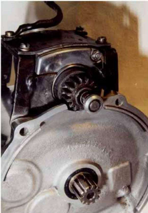
Elektrisch 12V - klar, aber mit einer Hawker Energy (PC 680, 16 Ah ) tut man sich leichter. Speziell der Strom im Startmoment liegt mit diesem Starter bei ca. 120 A, wenn sich der Motor dreht bei ca. 60A (gemessen mit Speicherscope und Shuntwiderstand). Es empfehlen sich kürzest mögliche Leitungslängen.
